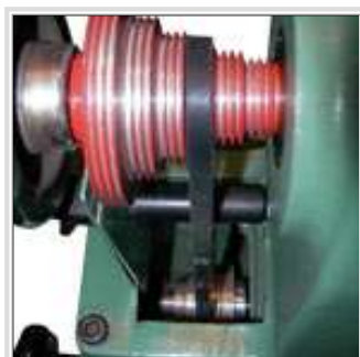
Entraînement en douceur par courroie en "V"
